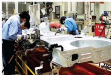
MIG钎焊采用低熔点的铜基焊丝代替碳钢丝，母材不熔化，焊接热输入量大约每单位长度减少约20%，焊接变形小，锌的蒸发降至最低。同时，MIG钎焊具有良好的间歇容忍性和搭桥能力，焊接时几乎无飞溅，焊缝接头强度高。已广泛用于通用、大众等著名品牌汽车生产上。
